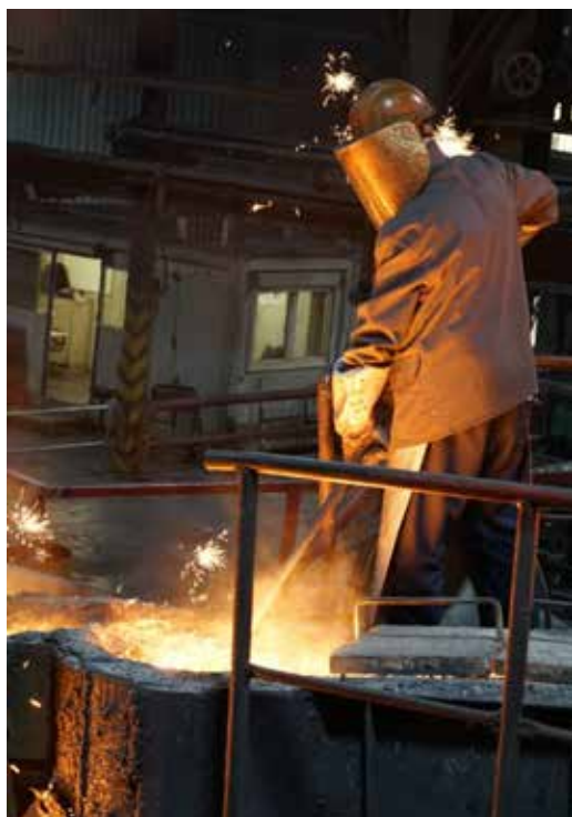
Abb. 2: Eisenabstich und Ablauf der flüssigen Schlacke beim Kupolofenbetrieb (Beispiel Luitpoldhütte AG Amberg 2015)
