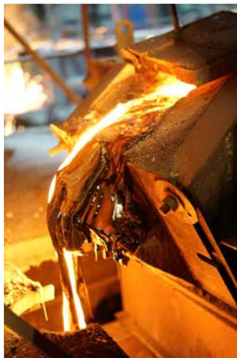
Abb. 2: Eisenabstich und Ablauf der flüssigen Schlacke beim Kupolofenbetrieb (Beispiel Luitpoldhütte AG Amberg 2015)
